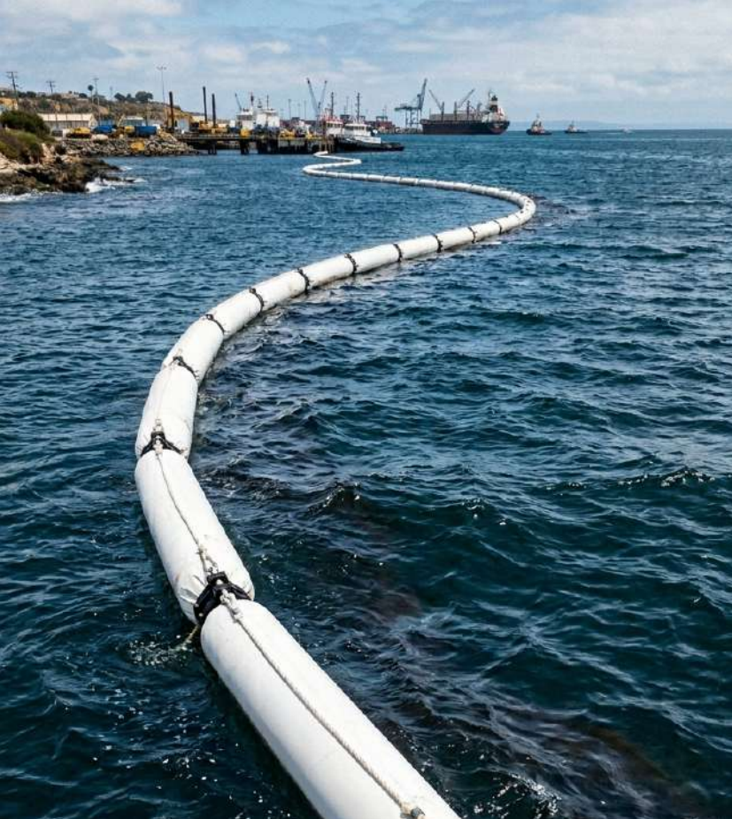
Barrera de contención de derrame / Oil spill containment barrier
